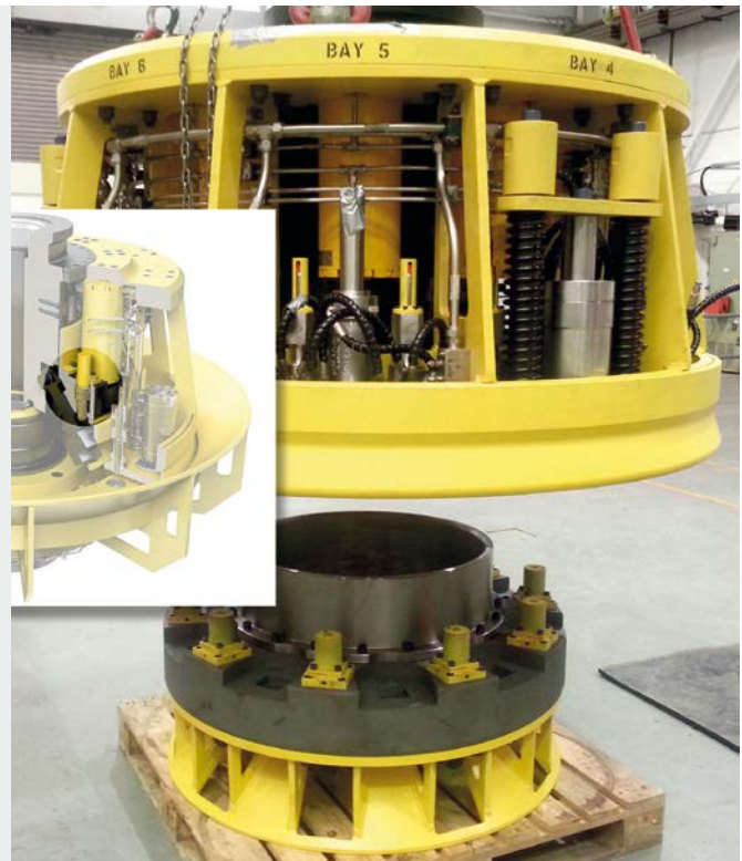
MAGNUMS ermöglichen zur Not schnelle Trennung der Pipelines von Bohriseln Subsea Technologies Ltd, Aberdeen, AB12 3AY, Vereinigtes Königreich
