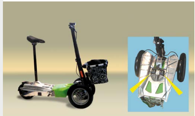
Strukturdämpfer erhöhen Fahrkomfort eines Elektro-Scooters
